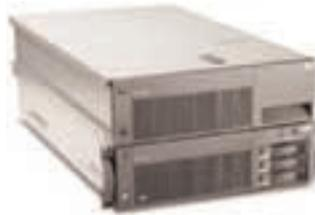
ния новостей это единственный сервак с процессорами такой архитектуры. Причем кроме внушительной мощи, сервер отличается и удобством: возможно использование блока дополнительных слотов с 12 дополнительными слотами расширения PCI-X; до 3-х блоков питания по 370W с горячей заменой; до 8GB оперативной памяти DDR; и конечно же корпус, высотой 3U, предназначенный для установки в стойку.
