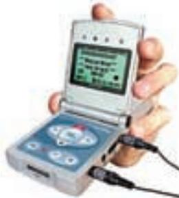
Также начинка состоит из 24-разрядного 100 МГц цифрового сигнального процессора Motorola Symphony DSP с битрейтом 32, 64, 96 и 128 Кб/с и частотой дискретизации 16, 32, 44,1 и 48 кГц. Довольно неплохо, осталось только дождаться появления этого плеера в свободной продаже.
