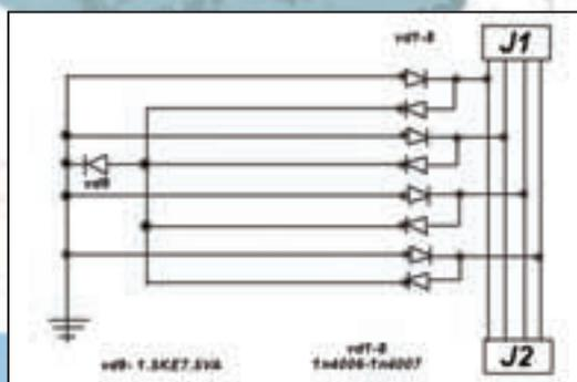
**Пояснение к схеме: Детали D1-D8 - диоды 1n4006-1n4007, D9 - защитный диод 1.5KE 7.5VA**
