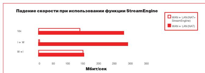
Падение скорости при использовании функции StreamEngine: как видно, при активации этой функции очень серьезно страдает пропускная способность LAN → WAN.
