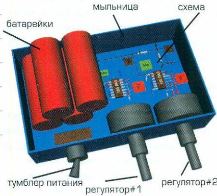
Металлоискатель внутри (объемная модель)
