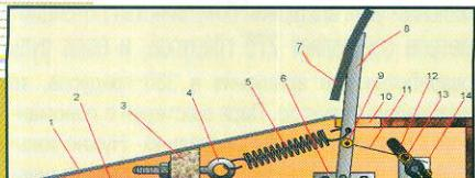
1 - Стальная панель; 2 - Основание; 3 - Поперечина; 4 - Винт с ушком; 5 - Пружина возврата; 6 - Монтажный кронштейн; 7 - Педаль; 8 - Стойка; 9 - Втулка; 10 - Лаз; 11 - Тяга; 12 - Привод потенциометра; 13 - Втулка; 14 - Кронштейн.
