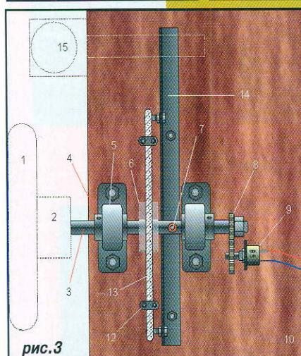
1 - Рулевое колесо; 2 - Ступица колеса; 3 - Вал (борт 12 мм х 180 мм); 4 - Винт (держит подшипник на валу); 5 - 12-мм подшипник в опорном кожухе; 6 - Центрирующий механизм; 7 - Болт-ограничитель; 8 - Шестерни; 9 - 100x линейный потенциометр; 10 - Фанерная основа; 11 - Ограничитель вращения; 12 - Скоба; 13 - Резиновый шнур; 14 - Угловой кронштейн; 15 - Механизм переключения передач.
