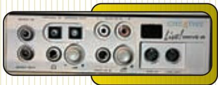
На нём расположены: две пары цифровых интерфейсов (RCA и оптические входы и выходы), регулируемый выход на наушники, совмещённый регулируемый микрофонный/линейный вход, линейный вход 2 для записи с бытовой аппаратуры (отдельные левый и правый RCA-разъёмы), MIDI-интерфейс, вход и выход. Естественно Live! Platinum 5.1 поддерживает все современные звуковые API:
