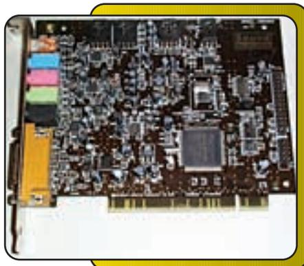
SoundBlaster Live! Platinum 5.1 построен на всё том же EMU10K и является уже третьим поколением креативовских звуковух, выполненных на этом чипсете. Отличительной особенностью Platinum является внешний модуль Live! Drive IR для 5-дюймового отсека.
