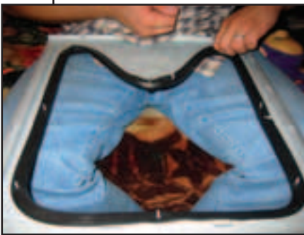
Вот таким образом протыкаем резиновый уплотнитель. Можно делать надрезы если он топорщится. С внутренней стороны.
