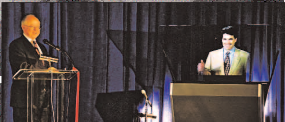
Цифровой телепортатор Teleportec. Модель Podium с рабочей зоной телепортации 1x0,75 метра. Стандарт видеоконференций H.323. Канал ISDN 384 Кбит/с.
