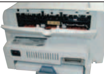
Сверху - откидывающаяся крышка для печати без перегиба. Снизу виден LPT-порт и задняя часть лотка
