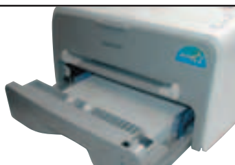
Лоток с датчиком наличия бумаги и щель для ручной подачи бумаги
