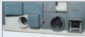
Типа справа налево: USB, разъем под опциональный слайд-модуль и собственно питалово
