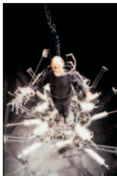
Шой Stelarc обыгрывает идею экзоскелета. Человек находится в центре шагающей шестиногой машины. Вращающаяся платформа оборудована «рукой» с пневматическим манипулятором
