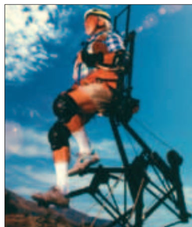
Экзоскелет SpringWalker на ровной поверхности развивает скорость 30 км/ч
