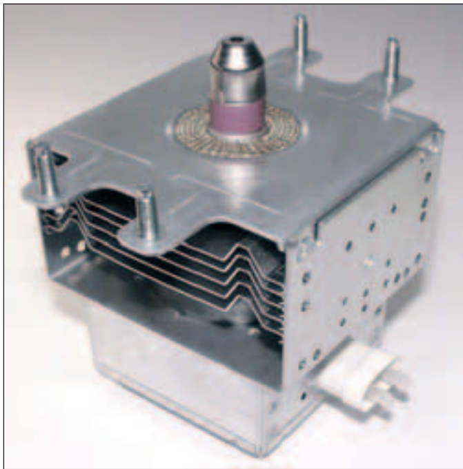
При помощи магнетрона из микроволновки можно соорудить настоящего убийцу для WiFi-точек
