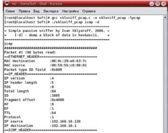
➤ Работает пассивный сниффер, написанный с использованием библиотеки libpcap. В командной строке задан фильтр: захватывать только ICMP-пакеты и показывать дамп (-d) hex&ascii
