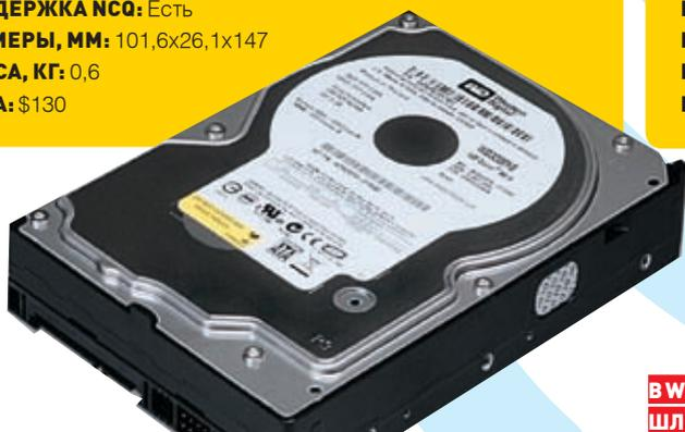
**ПРИ ИЗГОТОВЛЕНИИ WD3200YS ИСПОЛЬЗОВАЛИСЬ МАГНИТНЫЕ ПЛАСТИНЫ С ПЛОТНОСТЬЮ ЗАПИСИ 107 ГИГАБАЙТ.**
