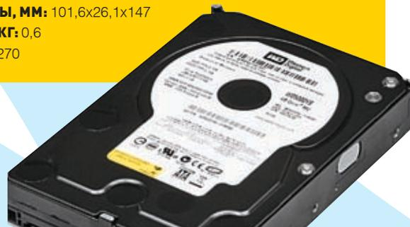
**В WD5000YS, ЧТОБЫ ДОСТИГНУТЬ ЕМКОСТИ В 500 ГИГАБАЙТ, ПРИШЛОСЬ УВЕЛИЧИТЬ КАК ЧИСЛО МАГНИТНЫХ ДИСКОВ, ТАК И ПЛОТНОСТЬ ЗАПИСИ (ДО 125 ГИГАБАЙТ), В РЕЗУЛЬТАТЕ МЫ ИМЕЕМ ОДНУ ИЗ ЛУЧШИХ СКОРОСТЕЙ ПОСЛЕДОВАТЕЛЬНОГО ЧТЕНИЯ.**
