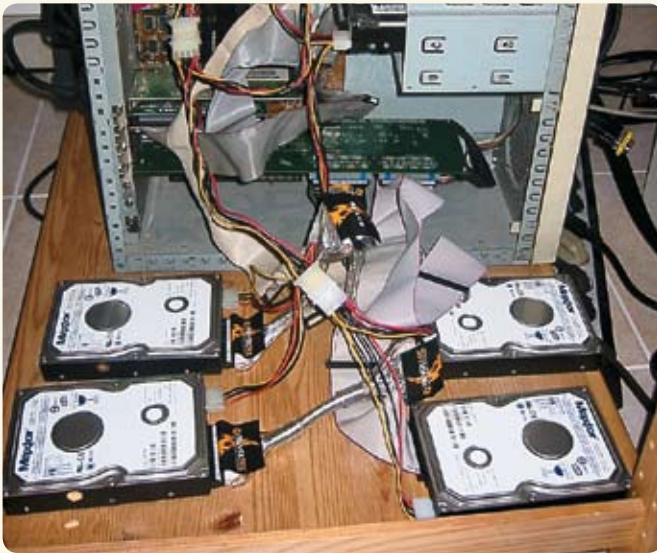
» Пяти дискам, объединенным в один RAID-массив, в бюджетном корпусе просто не хватило места!
