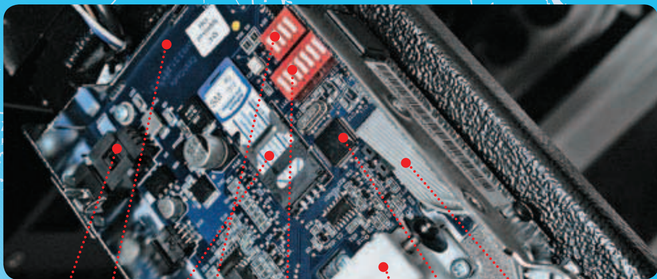
» Системная плата купюроприемника
