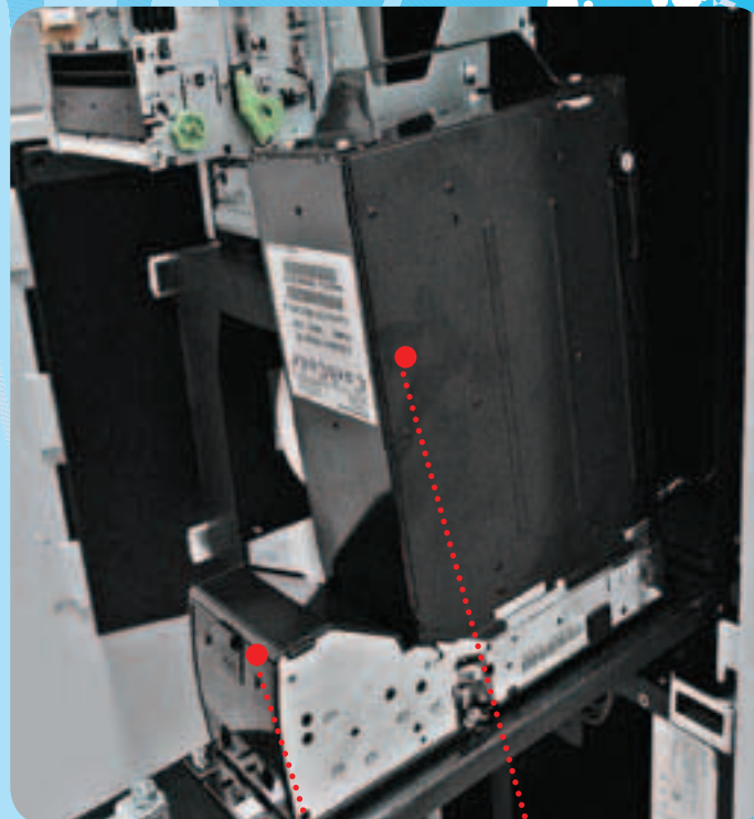
» Банкнотоприемник со стэкером
