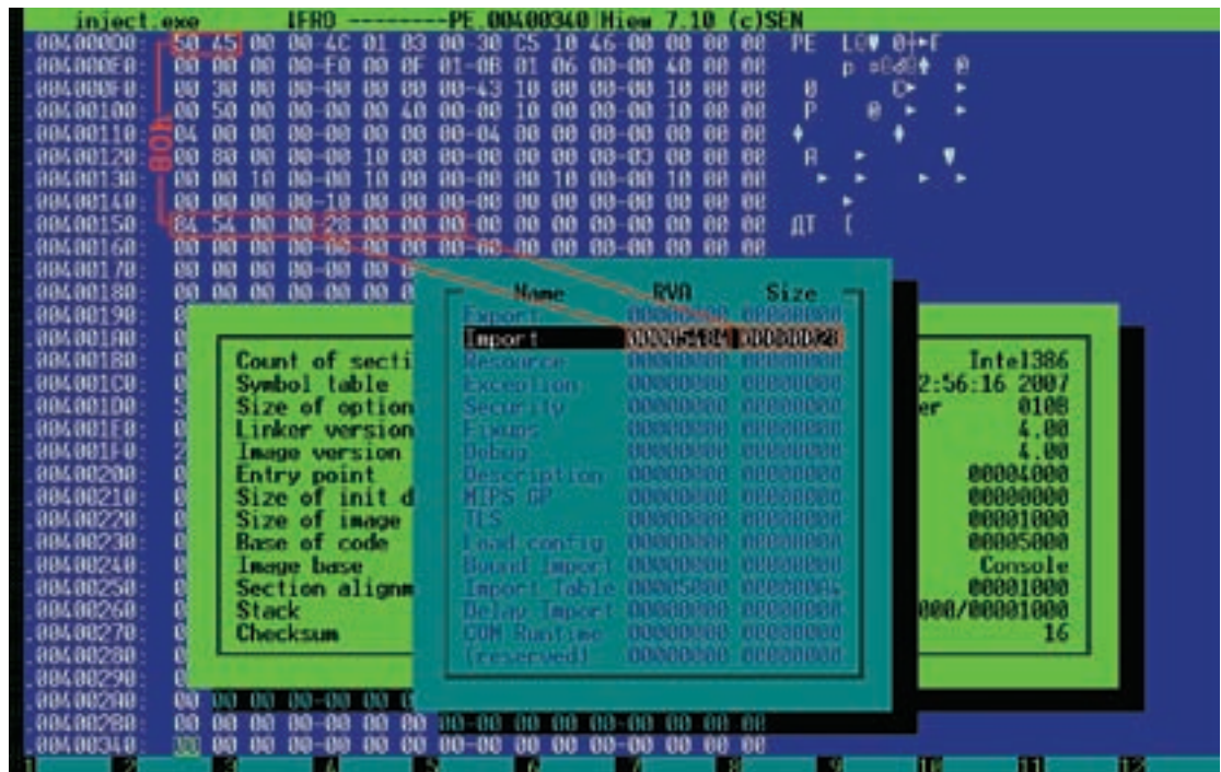
► Поиск указателя на таблицу импорта в hiew'e и в PE-файле
