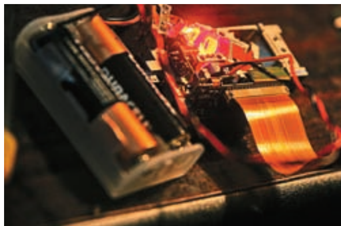
Снятая головка с питанием, поданным на лазер
