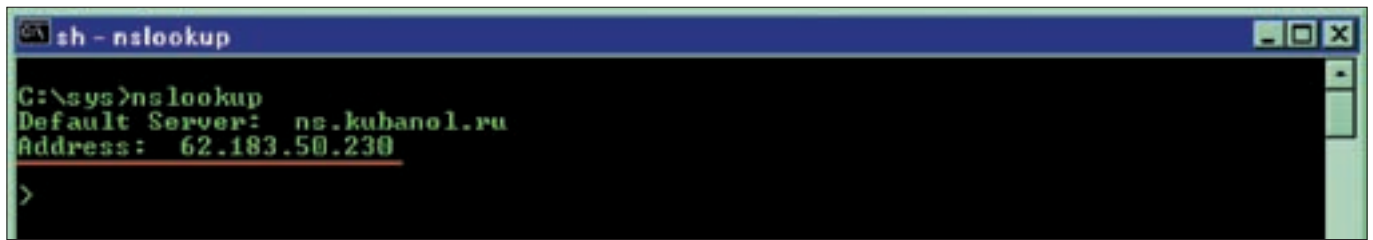
А вот так можно выяснить IP-адрес DNS-сервера провайдера с помощью штатной Windows-утилиты nslookup.exe
