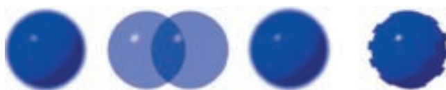
Слева направо действие фильтров при high motion: «-vf field=0», linear blend, median deinterlacing и адаптивный фильтр с компенсацией движения
