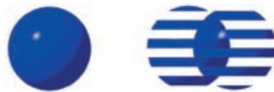
Так выглядит неподвижный (слева) и движущийся (справа) мяч, снятый в ч/с режиме и выводимый на прогрессивный монитор
