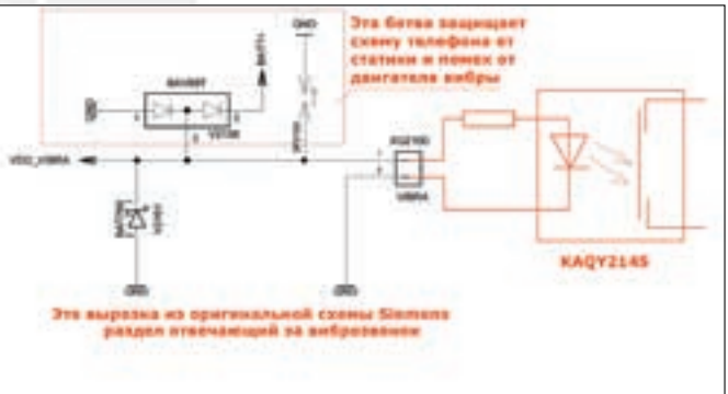
Вот так выглядит схемотехника виброзвонка. Красным помечен наш оптрон
