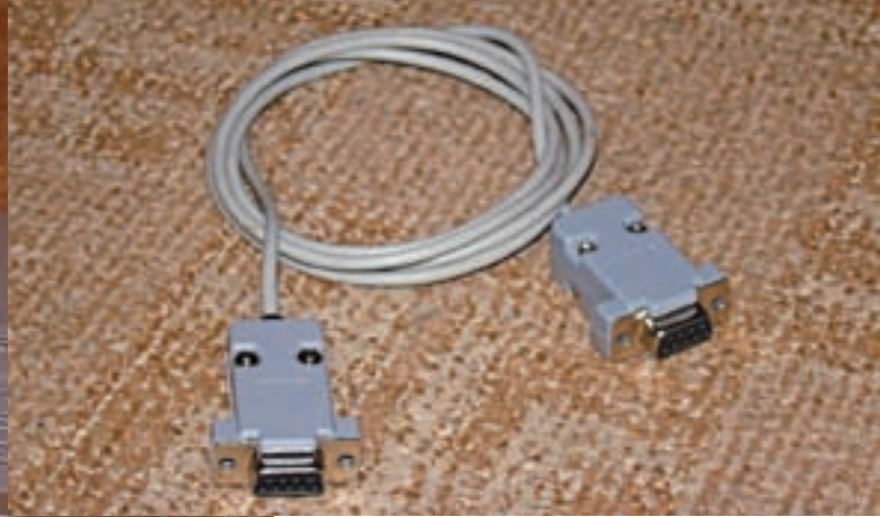
Соединительный кабель для связи ресивера и компа
