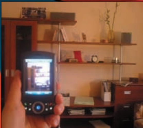
Шпионский девайс в руках: коммуникатор передает изображение по Wi-Fi на заданный IP-адрес
