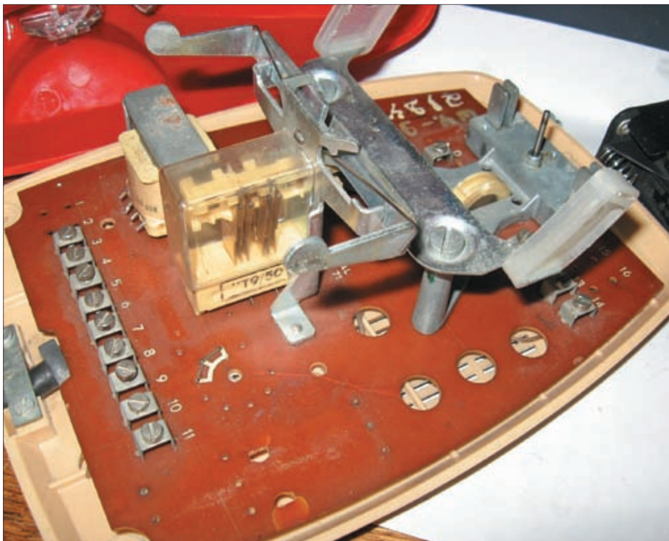
Выбрасываем все лишнее из телефона. Хорошо виден контакт снятия трубки
