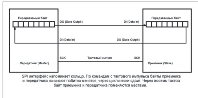
Передача байт по шине SPI
