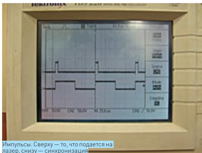
Импульсы. Сверху — то, что подается на лазер, снизу — синхронизация
