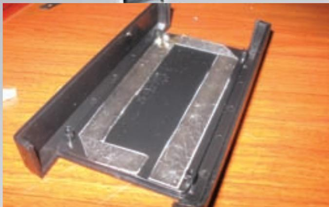
Наклеенная на корпус антенна
