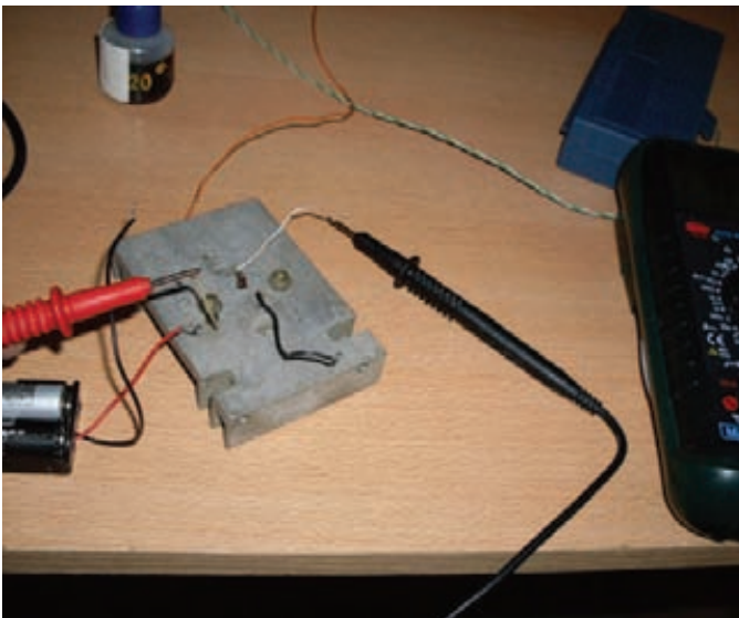
ПРОЗВОНИВ ТРАНЗИСТОР, Я ПРОСТАВИЛ БУКОВКИ «К», «Б», «Э»
