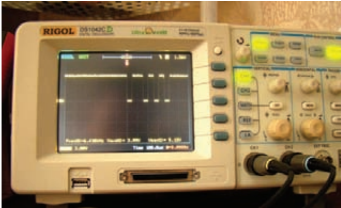
СИГНАЛ UART НА ЭКРАНЕ ОСЦИЛЛОГРАФА. ВИДЕН СТАРТ БИТ, ДАННЫЕ И СТОПОВЫЙ БИТ
