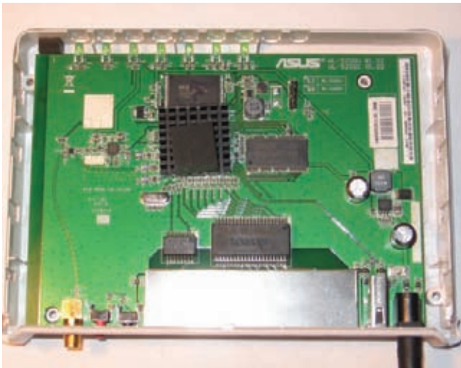
ВСКРЫТЫЙ РОУТЕР. ИГОЛКИ УЖЕ РАСПЯНЫ
