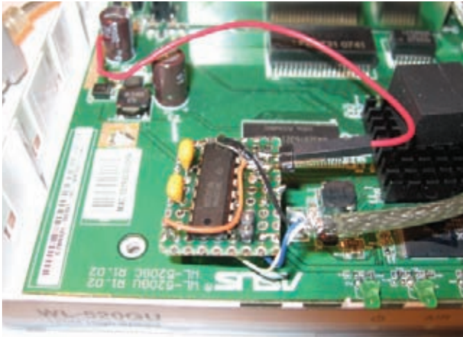
СОБРАННЫЙ И УСТАНОВЛЕННЫЙ ПРЕОБРАЗОВАТЕЛЬ ИНТЕРФЕЙСА
