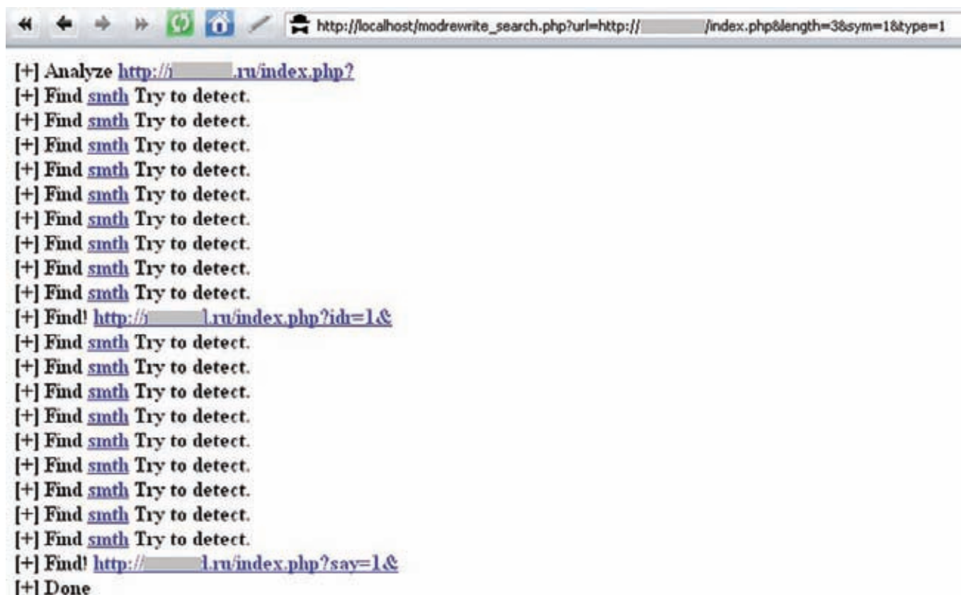
Пример работы фазера (перебор до 3 символов)
