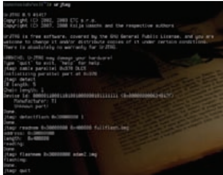
Работа с роутером через JTAG-интерфейс
