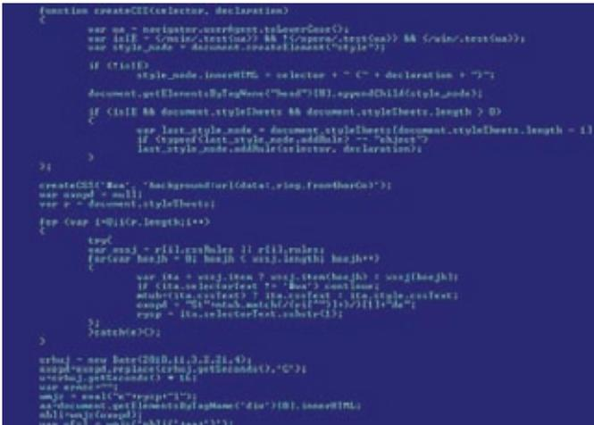
рис. 2. Фрагмент, содержащий расшифровывающий скрипт и основной html-скрипт
