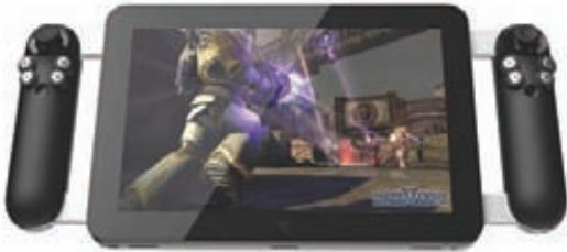
Предварительно озвучены следующие технические характеристики: экран размером 10,1 дюйма и разрешением 1280 x 800 пикселей, многоканальная звуковая подсистема Dolby 7.1 (проектируемая вместе с THX), средства беспроводного подключения Wi-Fi 802.11b/g/n и Bluetooth 3.0. Планируется также использовать акселерометры и сенсорный экран.
