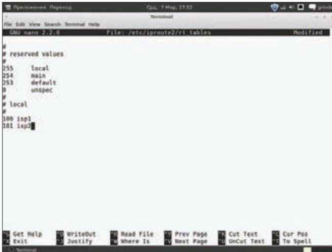
**/etc/iproute2/route tables** прописываем таблицы для каждого провайдера
