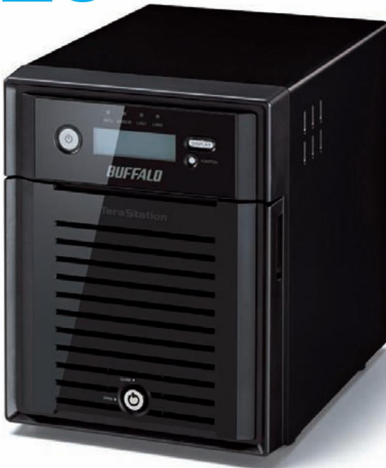
TeraStation TS5400D можно организовать сервер видеонаблюдения. В комплекте идет лицензия на одну камеру, а также заявлена поддержка более 1200 моделей камер от 184 производителей. Конечно же, Buffalo TeraStation TS5400D имеет поддержку принт-сервера.
