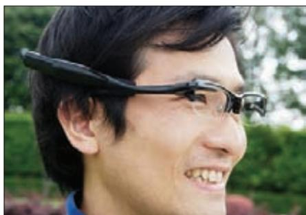
**К** Обещанное время автономной работы устройства доходит до восьми часов при включении на пятнадцать секунд раз в три минуты.
