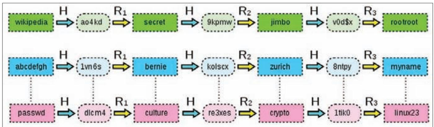
Схема упрощенной радужной таблицы с длиной цепочек, равной трем. R<sub>1</sub>, R<sub>2</sub>, R<sub>3</sub> — функции редукции, H — функция хеширования
