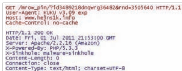
Рисунок 2. Соединение Salaty v3.09 с C&C сервером (command and control server)
