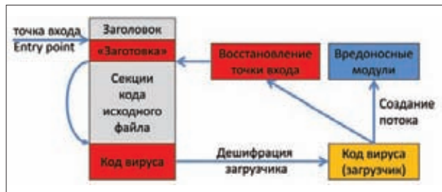
Рисунок 4. Структура вируса и процесс запуска
